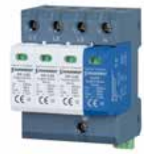
EP-C40/3+1 T2 Uc:275V,In:20kA, Imax:40kA (3 Faz+N, C Sınıfı, 40 kA)
